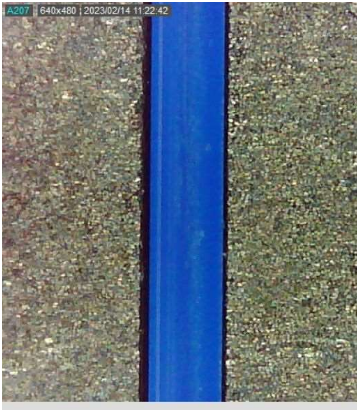
Vlákno 250 \mu m v držáku pro S712S-250
