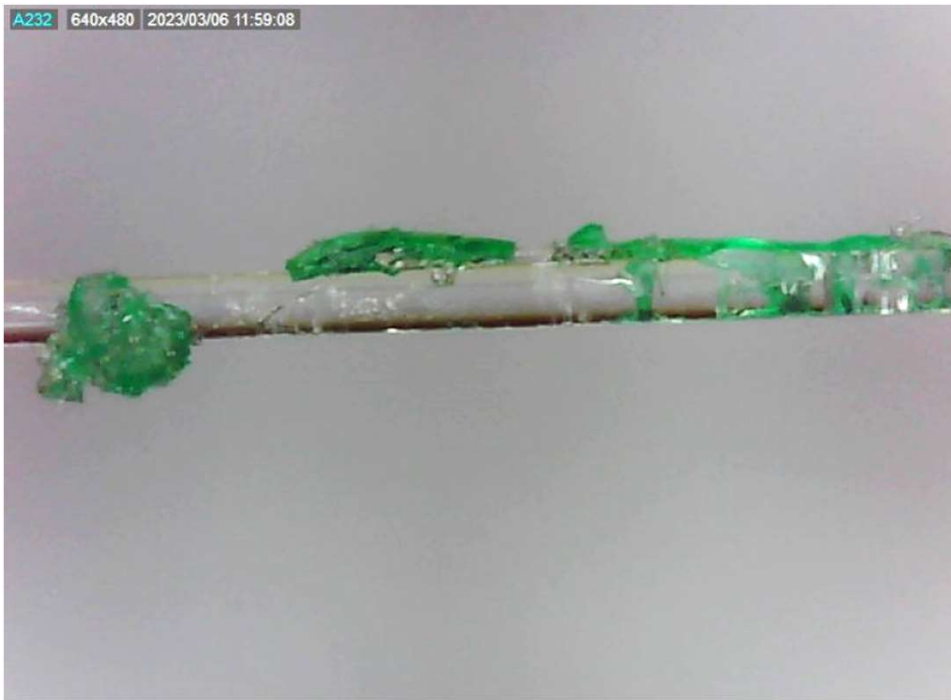
Vlákno 180 \mu m po odstranění primární ochrany pomocí strippovacích kleští
