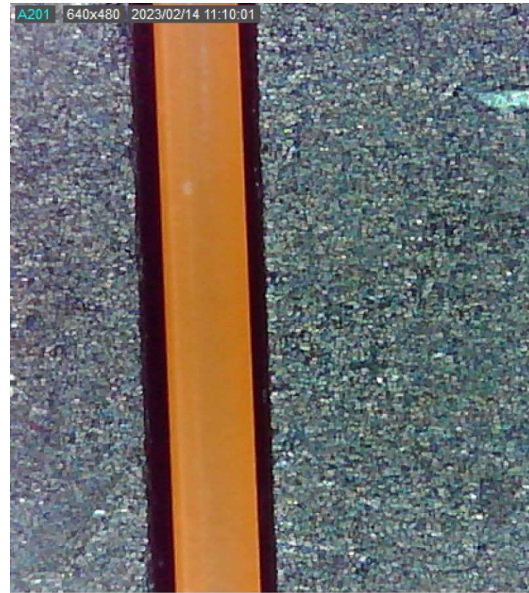
Vlákno 180 \mu m v držáku pro S712S-250
