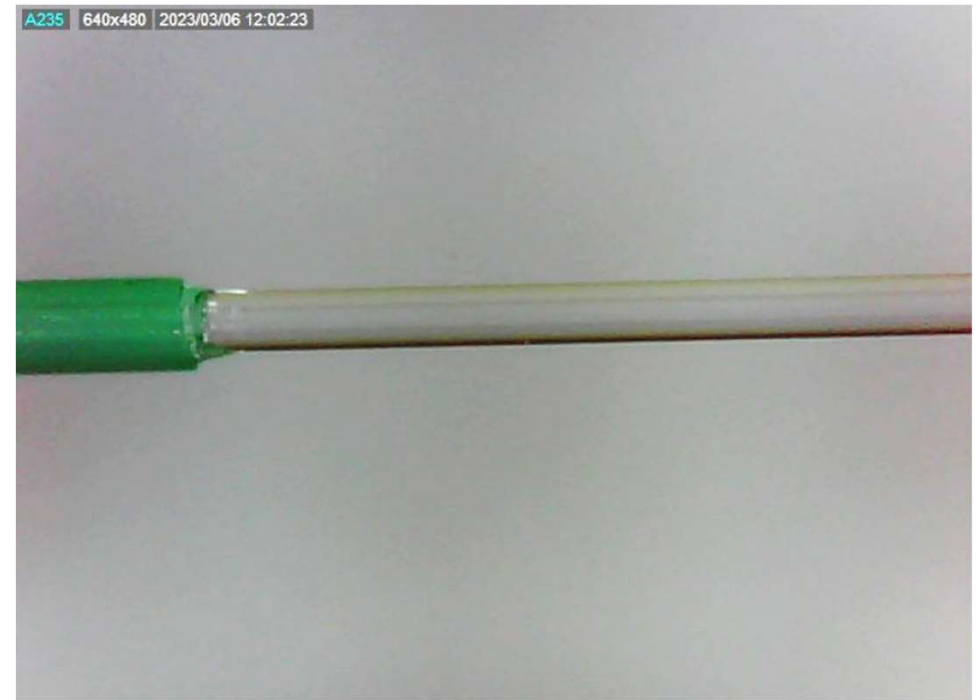
Vlákno 180 \mu m po čištění IPA + Kim Wipes
